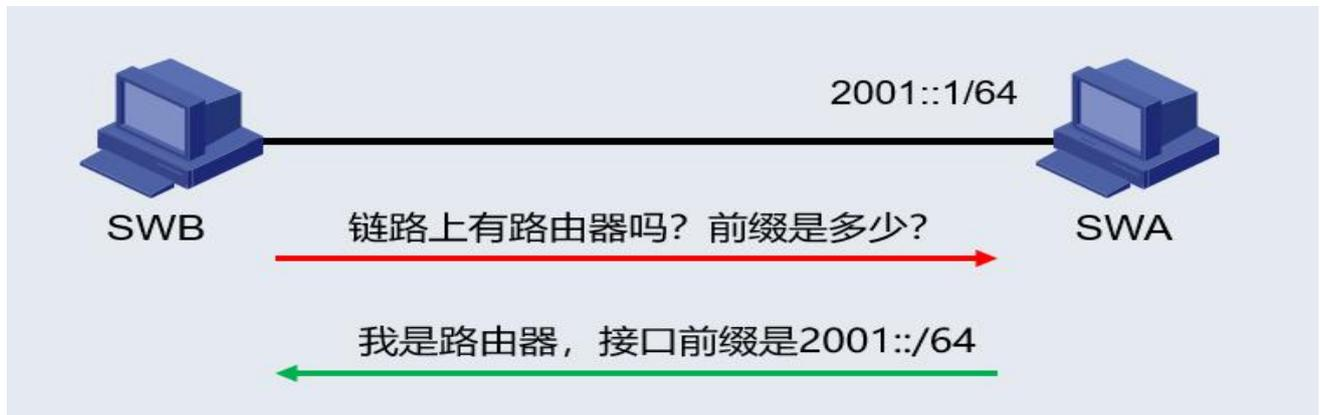
如图, SWA 交换机接口下配置取消抑制发布 RA 消息, SWB 交换机接口配置自动配置 IPv6 地址模拟终端, 查看 SWB 设备接口地址, SWB 获取到 SWA 的 IPv6 接口前缀并根据自己的接口 MAC 生成 IPv6 地址。
