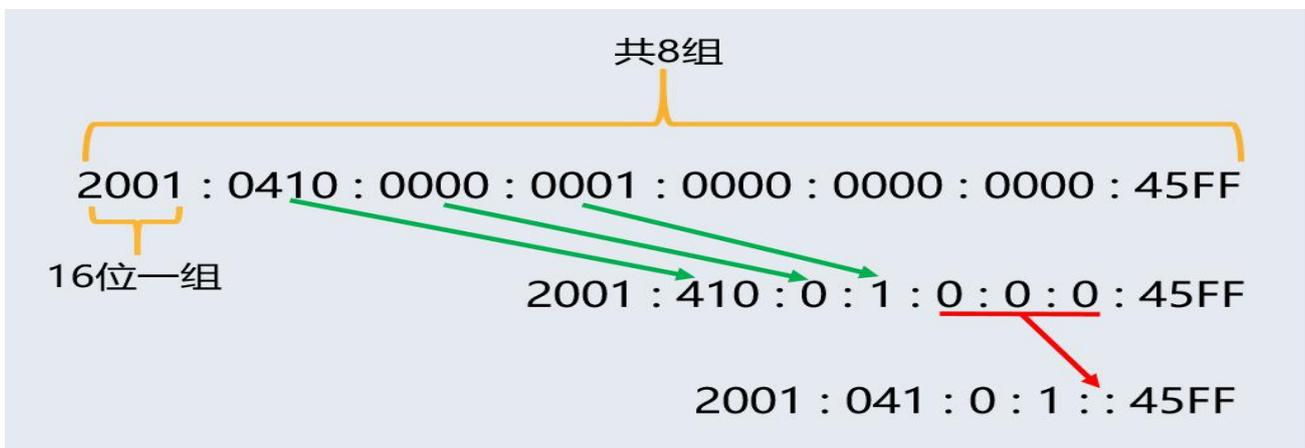
IPv6 地址被表示为以冒号分隔的一连串 16 比特的十六进制数，每个 IPv6 地址被分为 8 组，每组的 16 比特用 4 个十六进制数来表示，组和组之间用冒号隔开。
